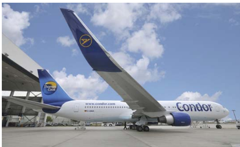
Die aerodynamischen Winglets der Boeing 767 verlängern die Tragflächen um rund zwei Meter und führen aufgrund des reduzierten Kerosinverbrauchs zu vier bis fünf Prozent weniger CO 2 -Emissionen.
