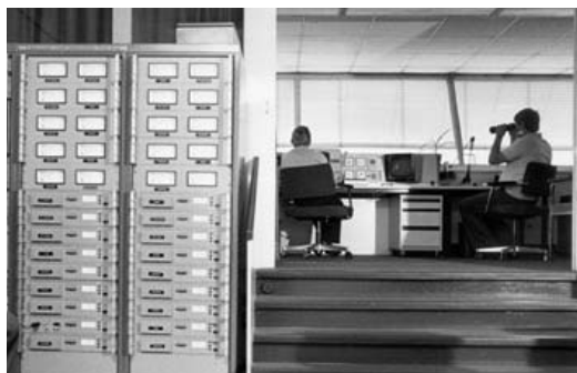
Anlage zur Fluglärmüberwachung (80er-Jahre)
